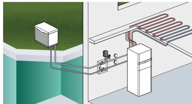
Luftkollektor außen, Wärmepumpe innen
